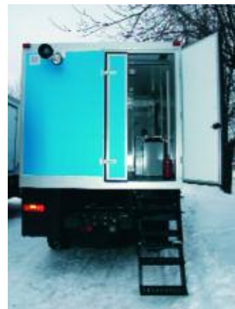
Распахнутая дверь в рабочий отсек с фиксаторами в открытом положении. Фара-прожектор. Громкоговоритель для подачи команд. Лестница складная
